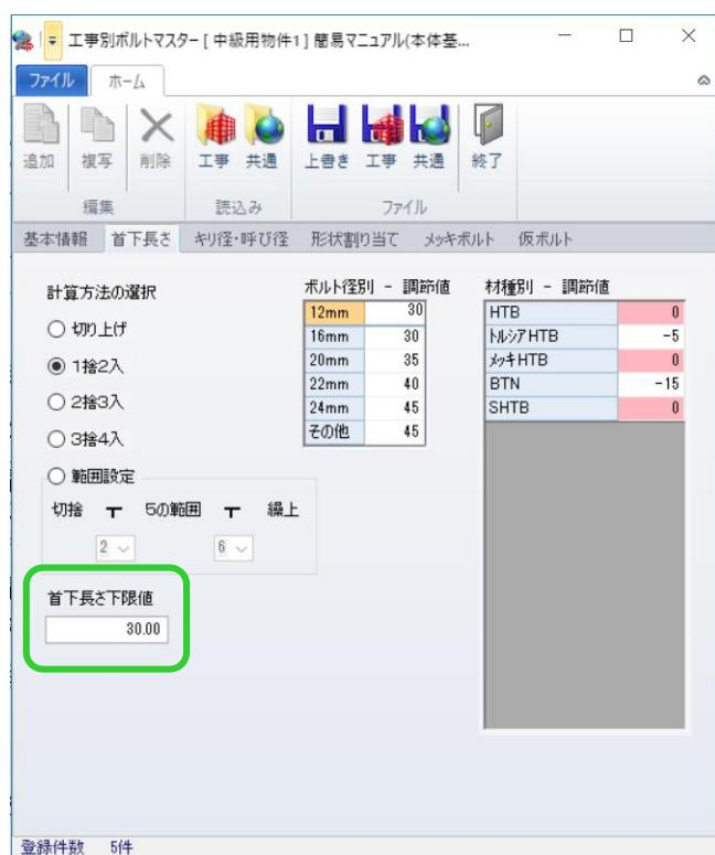
使用ボルト長さの登録がない場合、ボルトマスターの首下長さの設定内容で自動計算したボルト首下長さになります。
