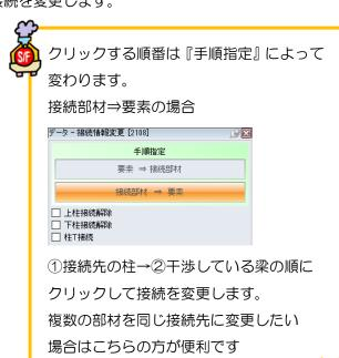
軸組図で柱頂部を階高や部材に接続すると勾配が反映しなくなります。
