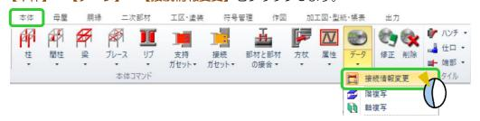
①干渉している梁の端部→②接続先の柱の順にクリックし、接続を変更します。
