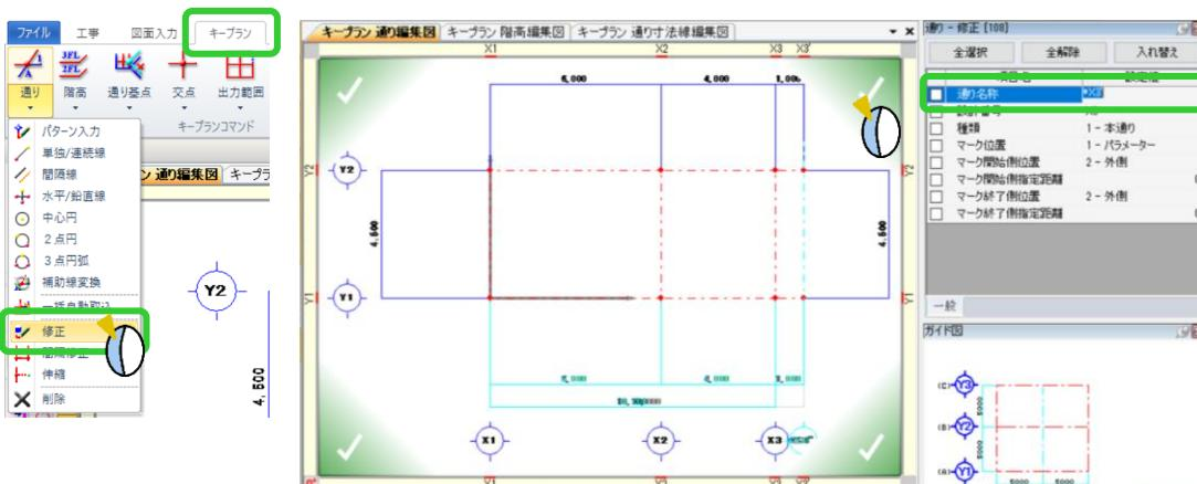
全体の寸法 (10,000) と片持ち梁先端の通りまでの寸法 (1,000) を分けて作図します。
