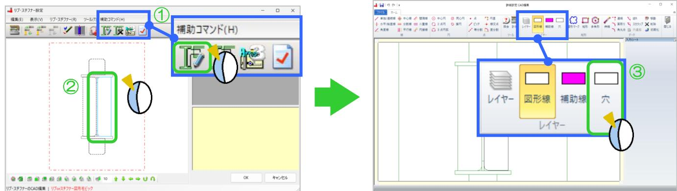
穴を開けたい位置をクリックし、穴の種類と穴径を設定しキーボードのEnterをクリックすると、リブに穴があきます。
