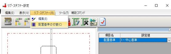
配置位置は【リブ・スチフナー】 - 【配置基準の切替】により中心基準・左基準・右基準から選択できます。また、ずれ量も同様のコマンドから設定できます。
