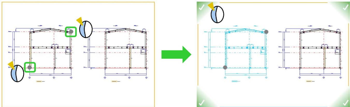
配置画面に戻り、取り込んだ図面を配置します。取込時に選択した基点と基点をクリックして配置します。
