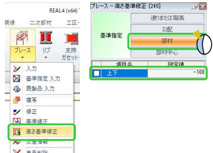
ブレース高さの基準になる大梁をクリックし、ブレースを右ドラッグで範囲選択して四隅の□をクリックします。
