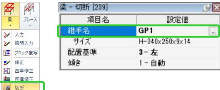
①棟部の通り②合掌梁となる梁の順にクリックすると梁を切断し、合掌プレートが入力されます。
