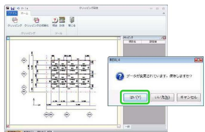
レイアウト設定画面に戻るので、【図面一覧出力】をクリックして、ファイルに出力します。
