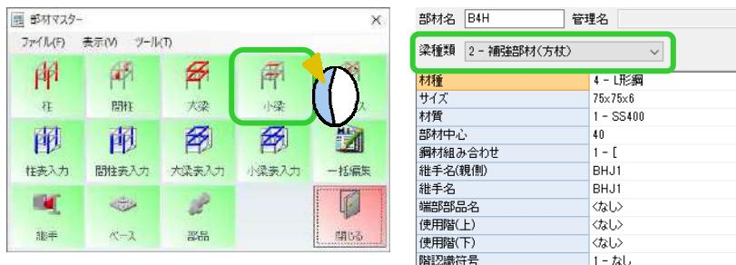
親梁側と子梁側で継手の形状が異なる場合は、『継手名（親側）』と『継手名』に異なる継手名を入力してください。
