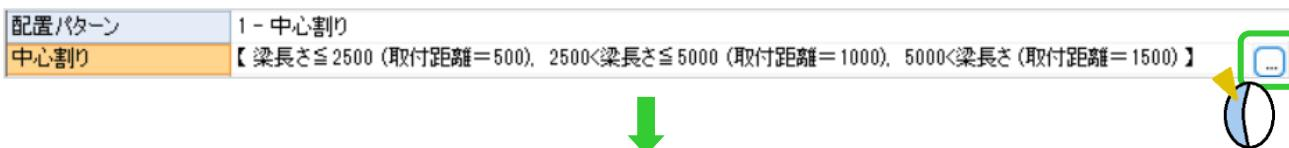
例) 長さ 4000 の梁に中心割りで吊ピースを配置する場合
