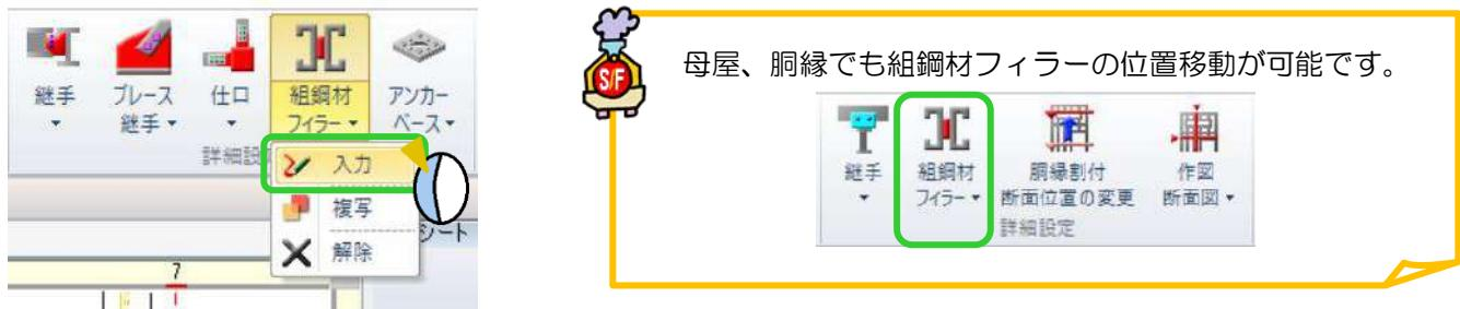
フライ位置を移動したい部材をクリックすると、組鋼材フライ設定画面が起動します。
