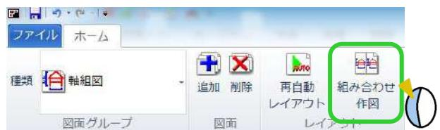
軸組図の組み合わせを設定します。
