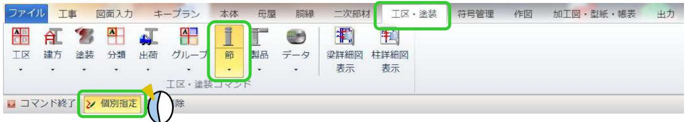
節を個別に設定したい柱を選択し、入力シートの[節の位置]に設定したい節番号を入力します。
