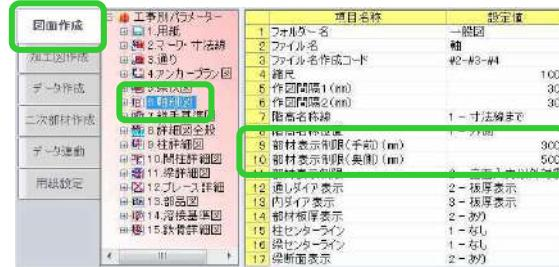
「9.部材表示制限（手前）(mm)」および「10.部材表示制限（奥側）(mm)」をそれぞれ設定します。
