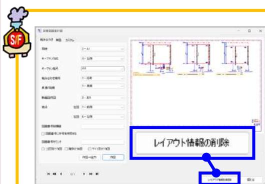
間柱/梁詳細図でレイアウト編集を行うと再作図する際に編集状態が優先されるため、レイアウト情報が初期化されない可能性があります。間柱/梁詳細図でレイアウト情報を初期化して再作図する場合は、間柱/梁詳細図の【詳細図図面作図】画面の【レイアウト情報の削除】をクリックすると、間柱/梁詳細図のレイアウト情報がすべてリセットされ再作図するときに自動レイアウトが可能となり、用紙サイズ・縮尺・パラメーターなどの変更が反映されるようになります。
