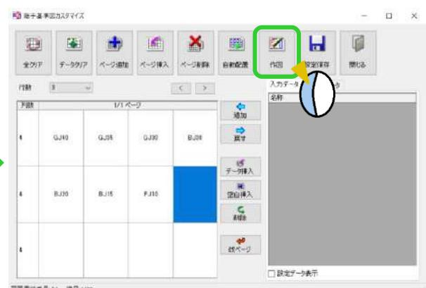
配置完了後に【作図】をクリックすると、設定した内容で作図が行われ保存されます。
