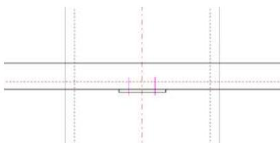
鋼材側が長穴になったことを確認します。長穴は加工図で確認ができます。
