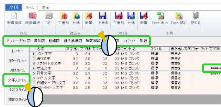
例えば「1,000」のように3桁目にコンマを入れたい場合は「#,##.#」と入力します。3桁目で区切り、小数点以下一桁まで表示する場合は「#,##.#.#」と入力します。
