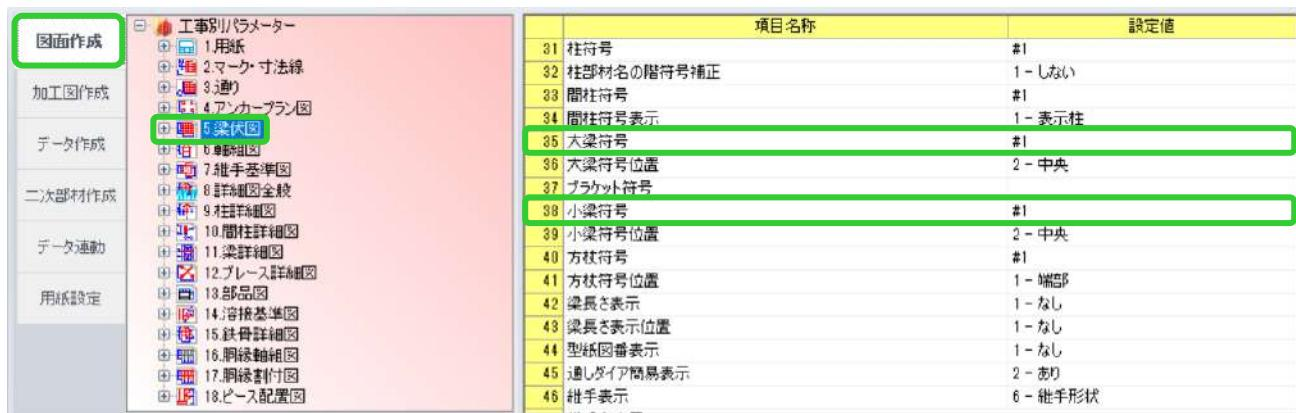
35) 大梁符号の設定画面を開いて鋼材符号名(#2)を選択し、OKをクリックして下さい。
