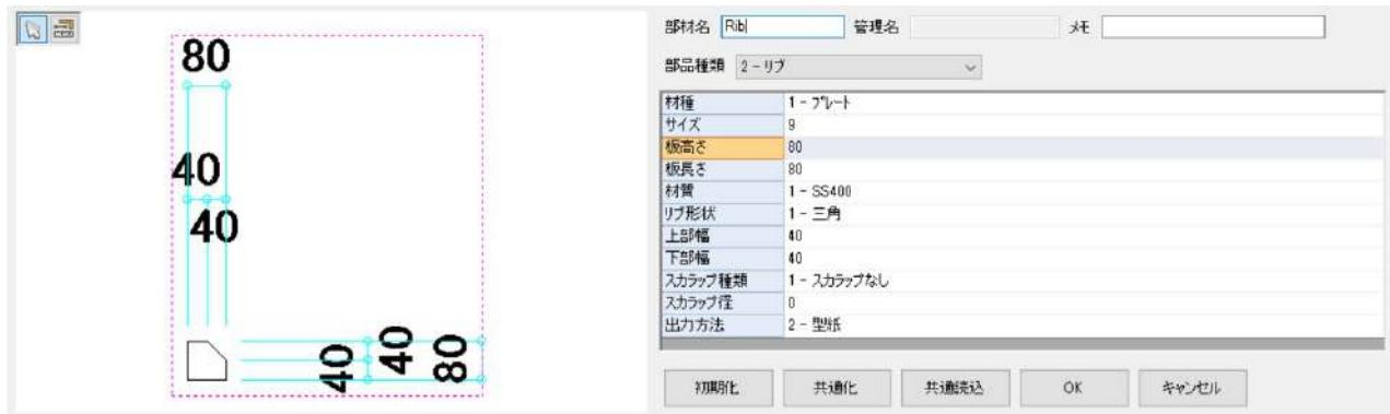
【継手マスター】で補強リブを設定します。
