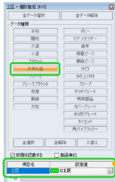
配置画面上で個別に工区設定したい鋼材をクリックし、四隅の□をクリックして設定します。
