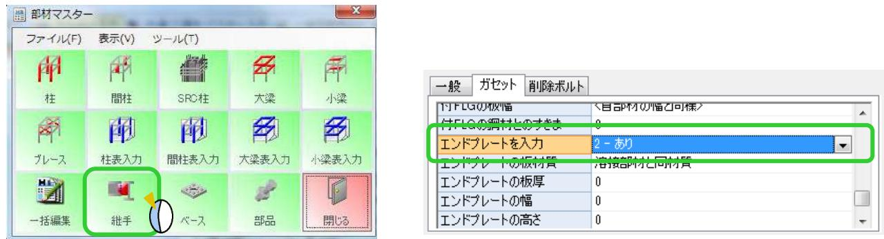
エンドプレートの板材質、板厚、幅、高さ等を入力します。
